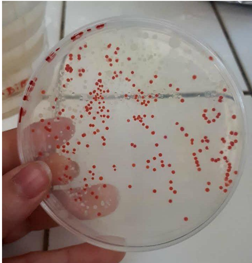
Figure 20 : Dénombrements des souches bactériennes sur gélose nutritive (bioaugmentation pétrole à T45).
