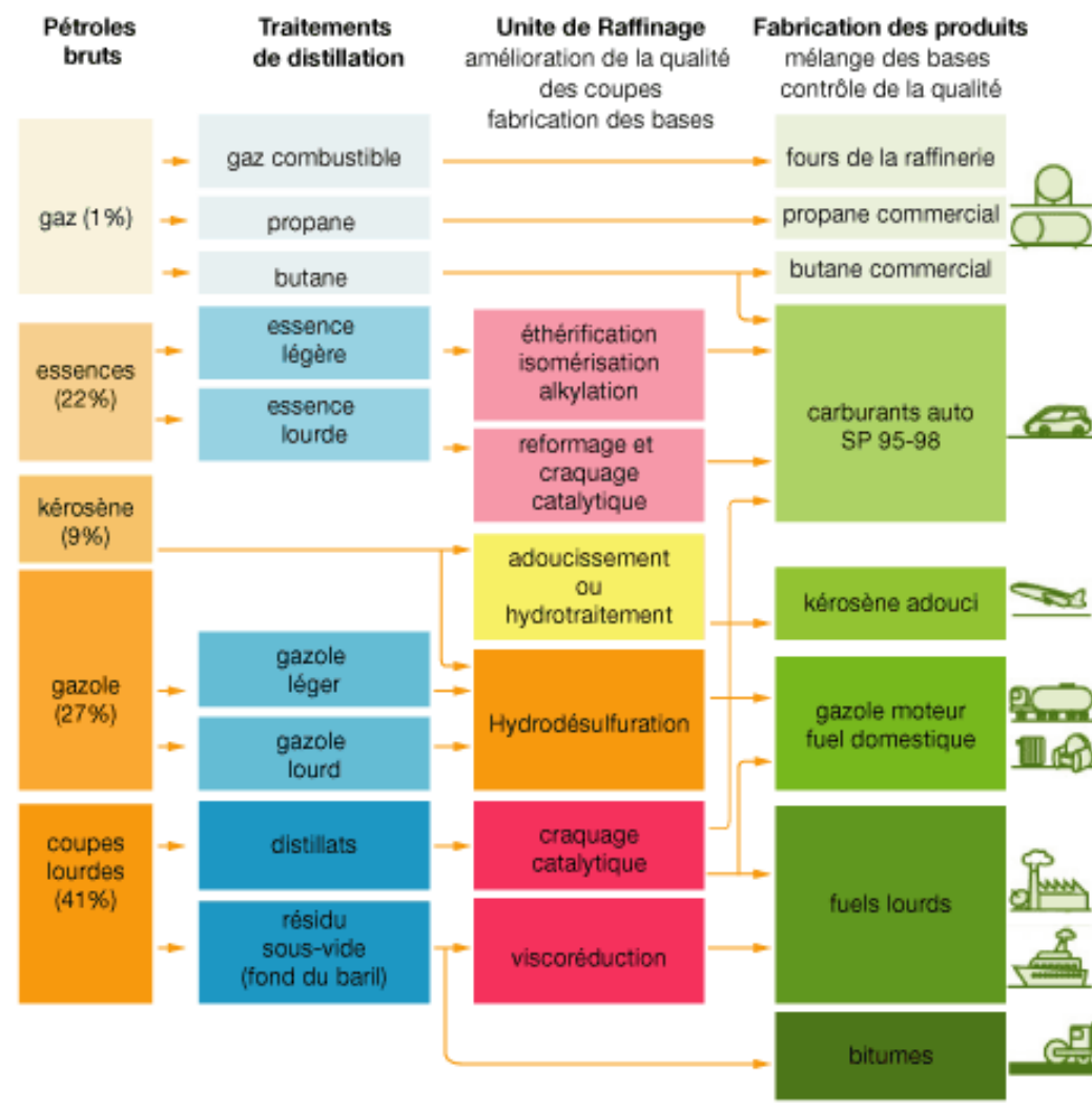
Figure 2 : Le processus du raffinage ( Deluzarche, 2006).
