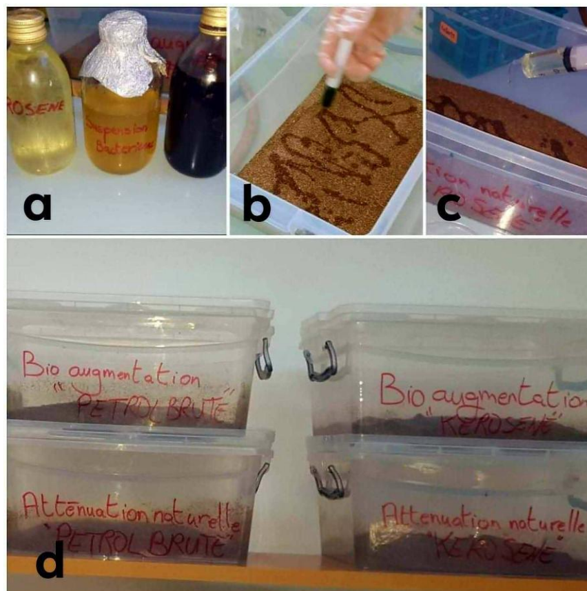
Figure 15 : Le dispositif expérimental ( a : les polluant + la suspension bactérien ; b : pollution du sol par le pétrole ; c : pollution du sol par le kérosène ; d : les bacs traités).
