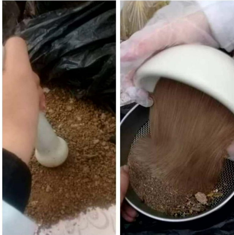
Figure 13 : Les étapes de préparation des deux échantillons du sol (broyage et tamisage).
